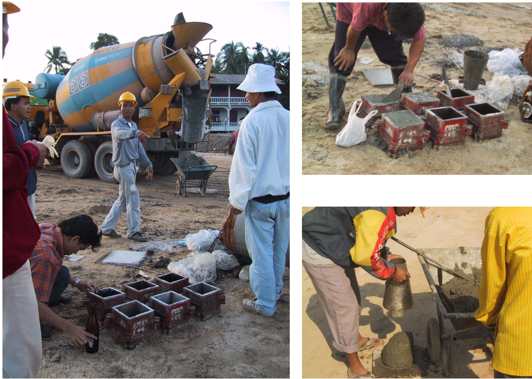
รูปที่ 4-3 การเก็บข้อมูลคอนกรีตภาคสนามเพื่อทดสอบในห้องปฏิบัติการ
